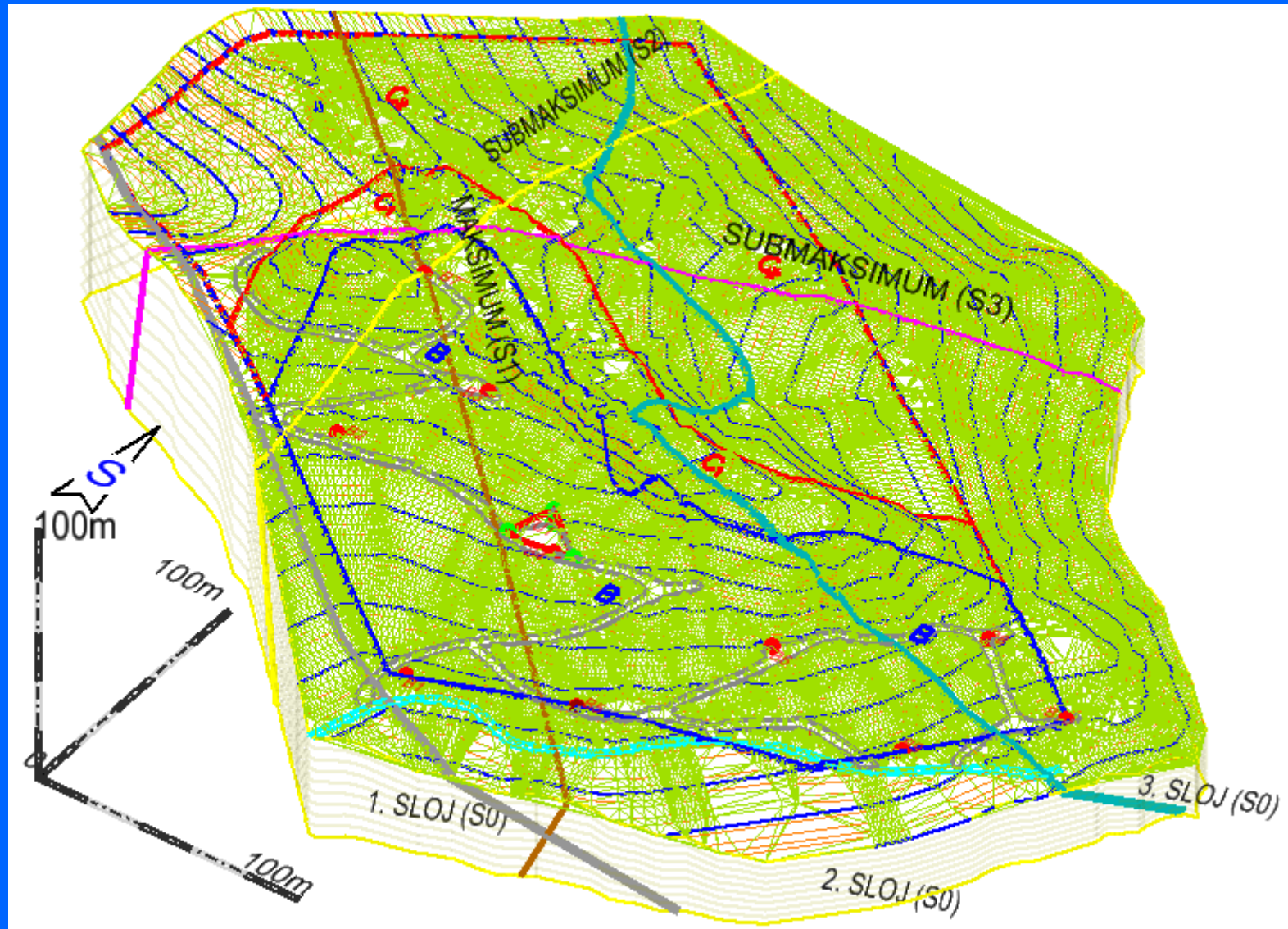
Slika 5.2.28 Prikaz geološkog modela ležišta a-gk u renderiranom wireframe obliku
